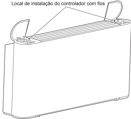
Figura 3-1 Posição de instalação do controlador com fios
